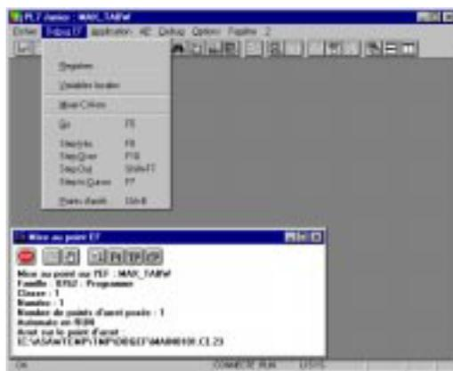
Для тестирования созданной функции она должна генерироваться в "отладочном" формате. После того, как функция будет внесена в приложение и загружена в ПЛК, ее выполнение можно проверить при помощи различных средств отладки.
