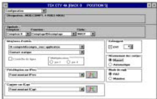
В стандартную конфигурацию включены некоторые инструменты для настройки различных приложений: дискретных и аналоговых входов-выходов, счетчиков, управления перемещением (1), человеко-машинного интерфейса (MMI), связи и взвешивания (1). Доступ к экранам параметров специализированных функций из экрана конфигурации входов-выходов обеспечивается простым щелчком на позиции, модуль которой следует определить.
