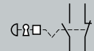
Кнопка аварийного останова с грибовидной головкой. Возврат посредством ключа - НО + НЗ контакты
