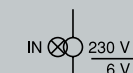
Сигнальные лампы со встроенным трансформатором: первичная обмотка 110/120 В, вторичная - 6 В, лампа накаливания с цоколем BA 9s
